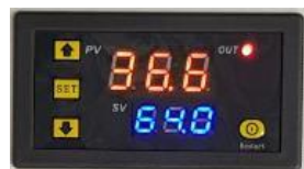
Indicateur de température du compartiment du moteur à air comprimé avec sonde
